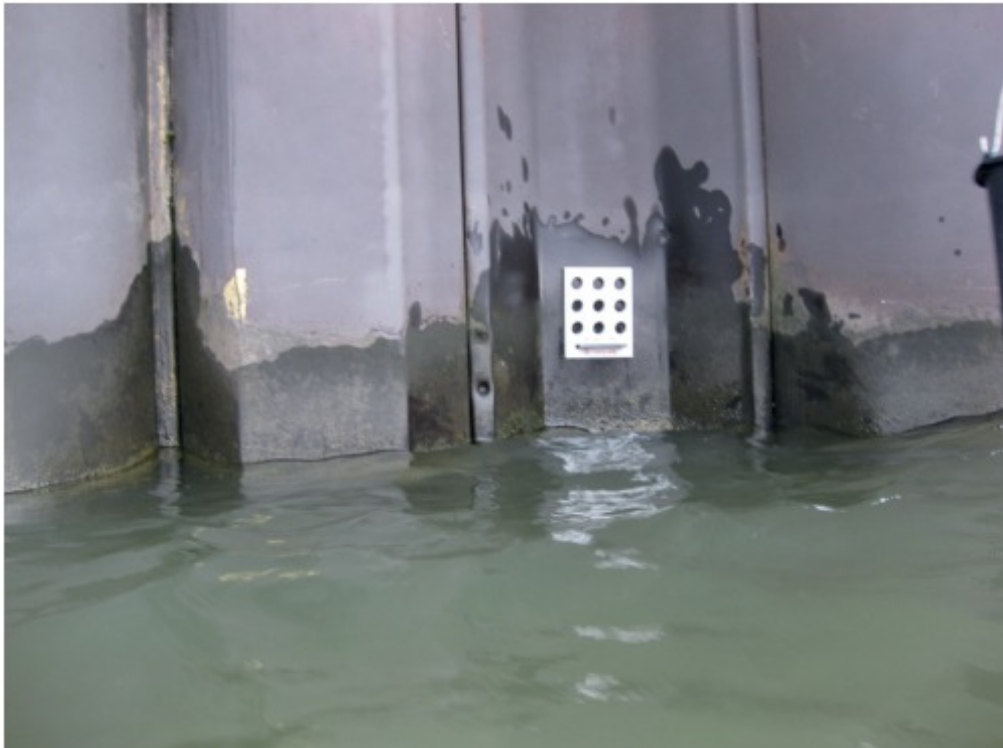
Figuur 3.10 Een meetmal voor negen ultrasonische metingen [CURSBRnet 2017]
