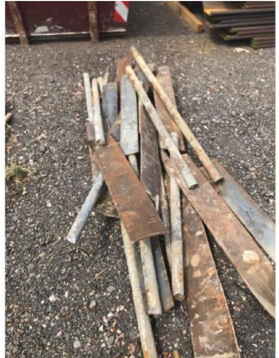
Figuur 80 Overige onbekende verankeringsonderdelen, vermoedelijk zijn de ankerstangen verzinkt.
