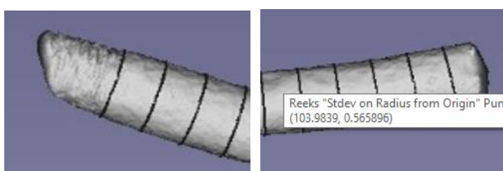
Figuur 168 Schroefdraad aan uiteinde ankerstang Loofr-01.
