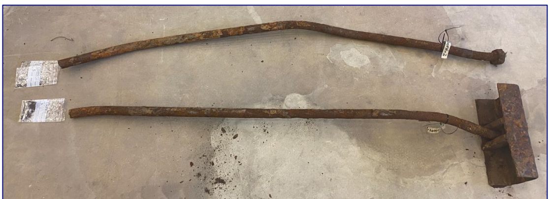
Figuur 75 Corrosie product ankers locatie Loofr – Lloofr-2 (boven) en Loofr-1 (onder) complete stang.
