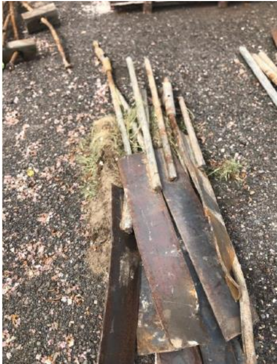
Figuur 80 Overige onbekende verankeringsonderdelen, vermoedelijk zijn de ankerstangen verzinkt.
